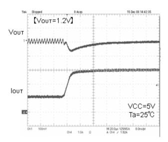
Fig. 17 Transient Response Io=1→3A(10µs)
