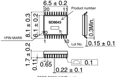
SSOP-B20W (UNIT: mm)
