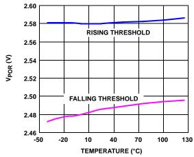
FIGURE 12. V<sub>POR</sub> vs TEMPERATURE
