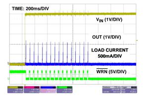
FIGURE 8. POWER-UP WAVEFORMS WHEN OUTPUT IS SHORT-CIRCUITED
