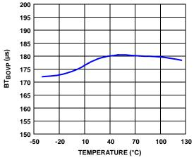
FIGURE 18. BATTERY OVP BLANKING TIME
