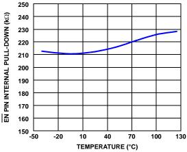
FIGURE 21. EN PIN INTERNAL PULL-DOWN RESISTANCE
