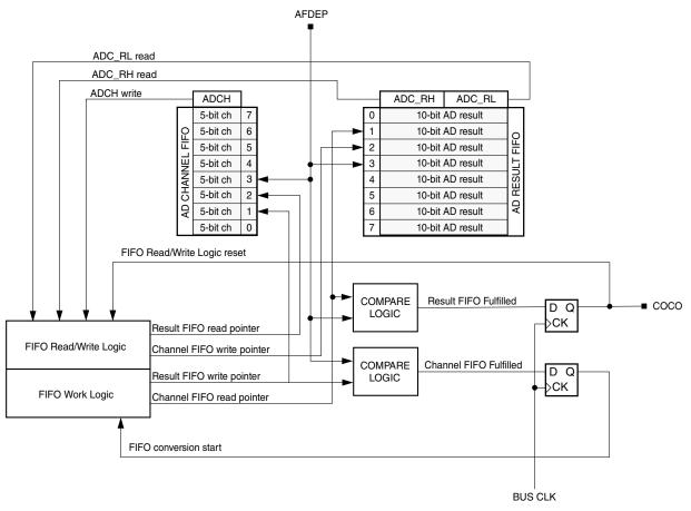
Figure 15-2. FADC FIFO structure
